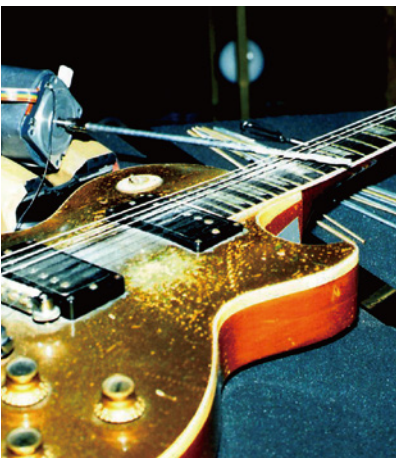
モーターに棒を付け回転させてギターを鳴らす(筆者撮影)
